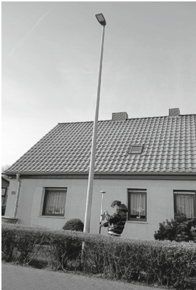
(Foto: Praktikant Gerrit Hoffmann beim genauen Erfassen der Straßenlaterne mithilfe des GNSS-Stabes)
