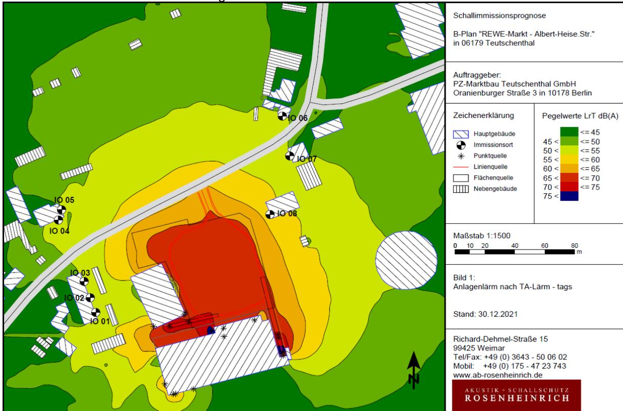
Abbildung 14: Auszug aus der Schallimmissionsprognose – Bild 1 – Anlagenlärm nach TA-Lärm - tags (Akustik Schallschutz Rosenheinrich – Stand: 30.12.2021) – unmaßstäblich
