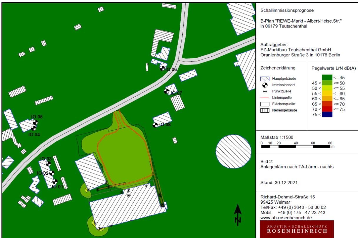
Abbildung 15: Auszug aus der Schallimmissionsprognose – Bild 2 – Anlagenlärm nach TA-Lärm - nachts (Akustik Schallschutz Rosenheinrich – Stand: 30.12.2021) – unmaßstäblich
